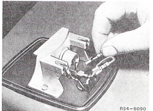
9 Introducir en la caja de enchufe las conexiones de la bombilla. Aplicar el manguito de cable.
