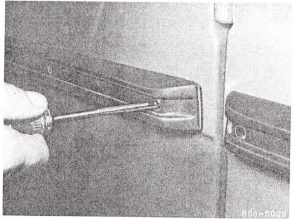
6 Atornillar el revestimiento del radiador por sus partes superior e inferior.
