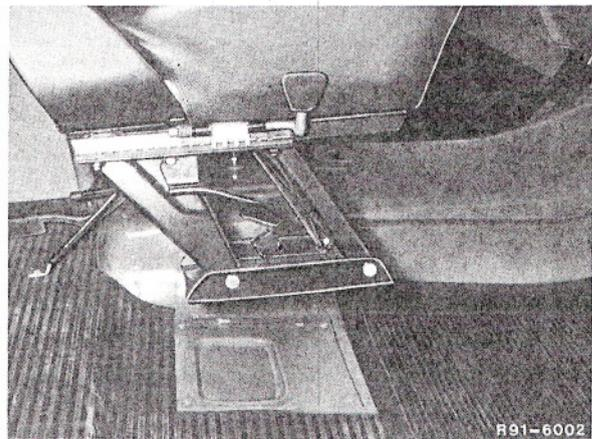
3 Soltar los tornillos laterales de fijación del respaldo.
