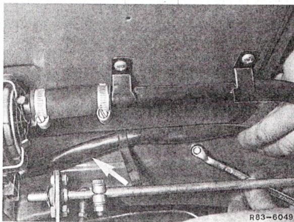
18 Soltar la fijación interior inferior de la caja de calefacción.
