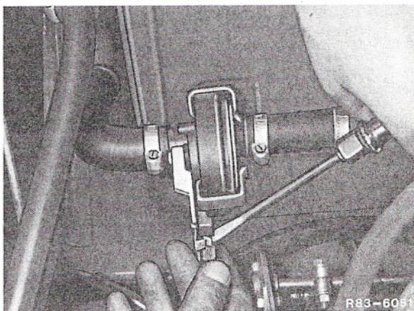
15 Soltar de la válvula de cierre y de la tubería rígida los tubos flexibles de líquido refrigerante.
