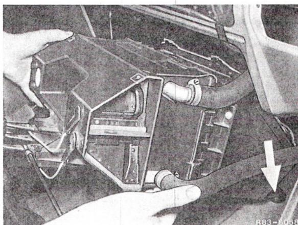
2 Fijar la caja de calefacción por los lados exterior e interior.
