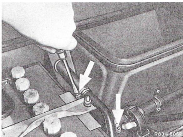
16 Soltar la fijación exterior superior de la caja de calefacción.
