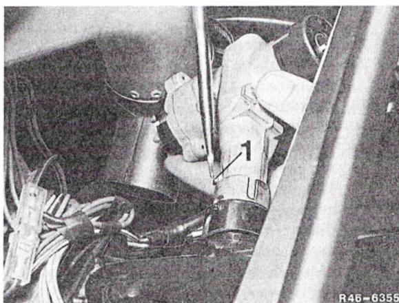
2 Calar el enchufe en el interruptor de encendido y arranque.
