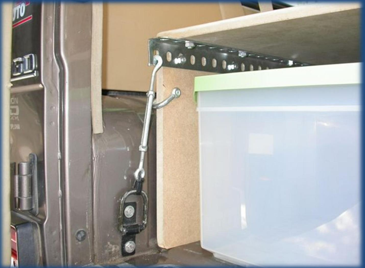
Por la parte interior se subdivide para darle solidez y evitar desplazamientos del equipaje y se ancla aprovechando los agujeros de los asientos posteriores. Las patas del cajón se perforan para poder enganchar pulpos de goma.
